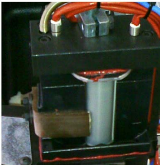
Figura 62. Rullo applicatore correttamente alimentato
