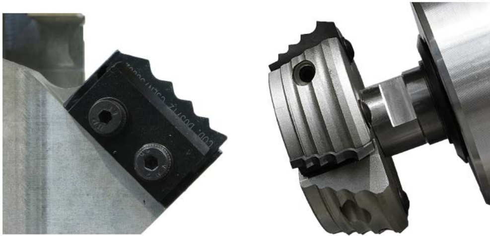
Figure 79. Esempio di utensili correttamente affilati
