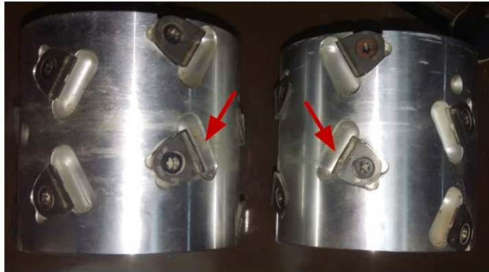
Figura 72. Esempio di utensili della rettifica usurati
