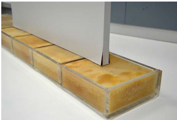
Figura 46. Prova di resistenza dei bordi all'acqua
