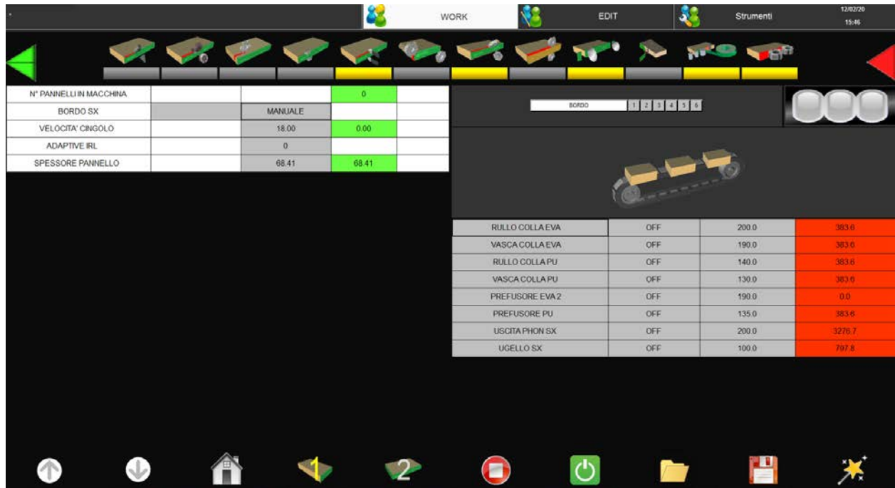
Figura 52. Parametri di fusione sul controllo della bordatrice
