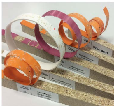
Figura 44. Bordi dopo la prova di peeling a 90°
