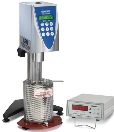
Figura 8. Viscosimetro rotazionale Brookfield con unità riscaldante
