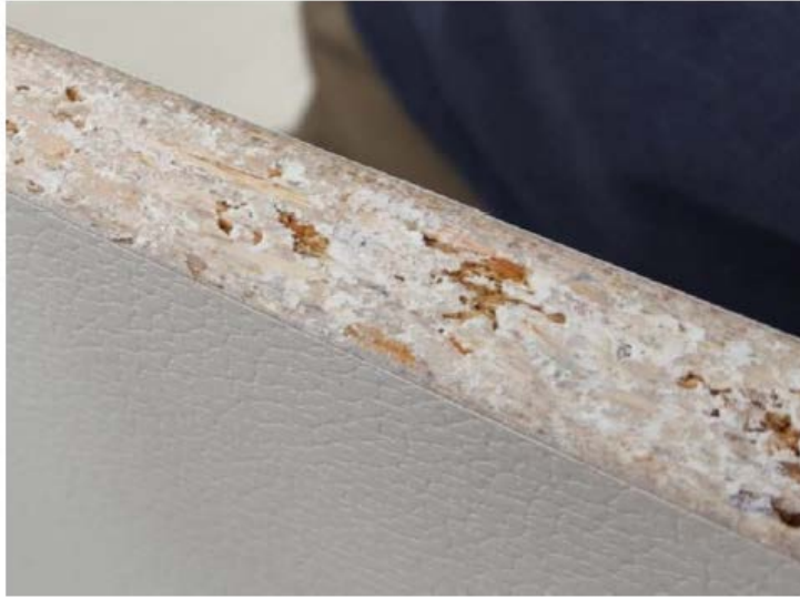
Figura 71. Esempio di strato funzionale delaminato
