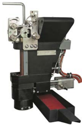
Figura 34. Rullo spalmatore alimentato dall'alto
