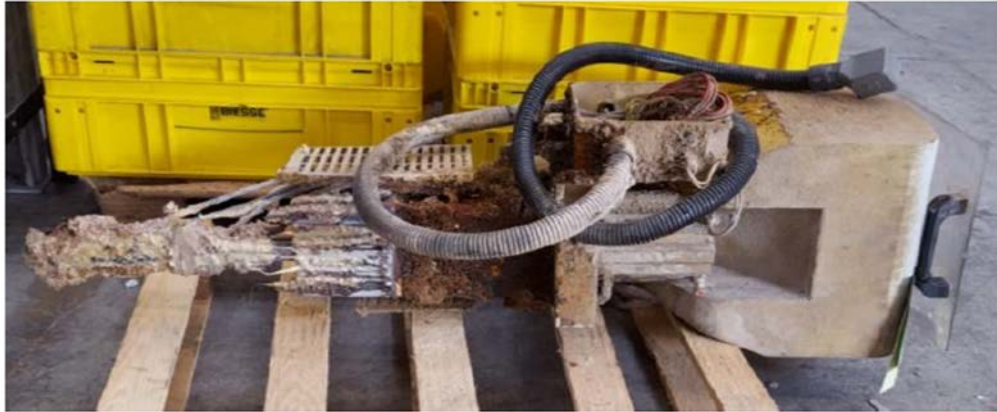
Figura 49. Esempio di prefusore non pulito
