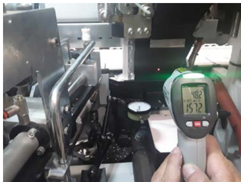
Figura 53. Termometro ad infrarossi su testina dell'adesivo
