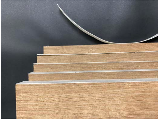
Figura 45. Prova di resistenza dei bordi al calore
