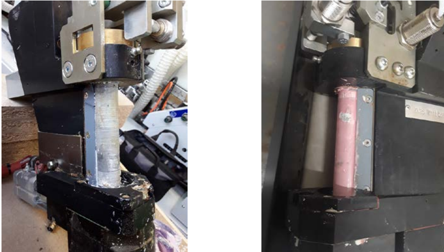
Figura 68. Esempi di testine con adesivo poliuretano reticolato
